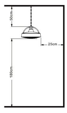
2. Fixez maintenant la chaîne de fixation fournie au crochet du support en accrochant une extrémité de la chaîne dans le crochet du support avec un mousqueton.
