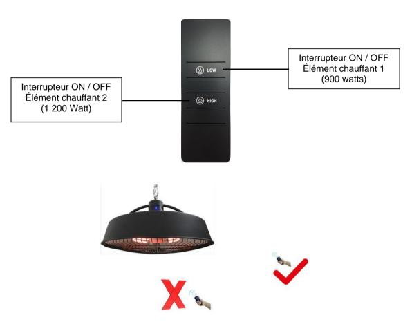
Veillez à contrôler la partie supérieure du chauffage radiant avec la télécommande. Le récepteur de la télécommande est situé à la hauteur de l'interrupteur principal. Par conséquent, le signal de la télécommande ne peut pas être reçu par le bas (voir l'exemple d'image ci-dessus).
